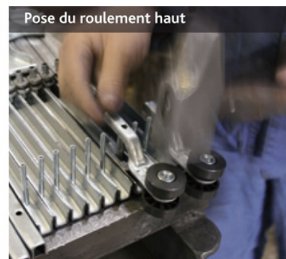
Alignement des barreaux supérieurs
