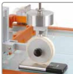
Système de changement rapide d'outils, pour tester les spécimens plats et courbes simultanément et conformément aux différentes normes en vigueur.
