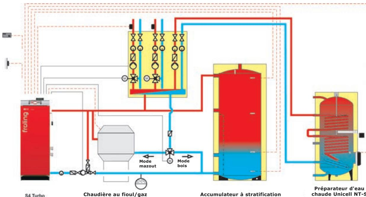
S4 Turbo avec chaudière au fioul/gaz, accumulateur stratifié et chauffe-eau
