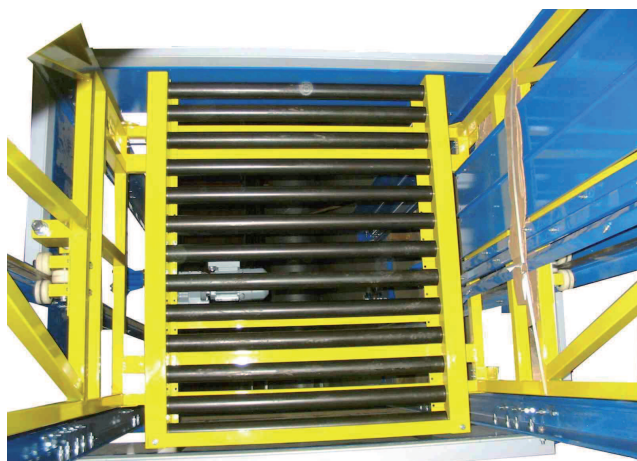
Vue d'un élévateur pré-assemblé prêt pour expédition
