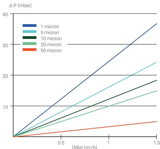
Perte de charge initiale typique  $\Delta P$  par élément de 254 mm (10»), eau à 20 °C, viscosité 1 cP
