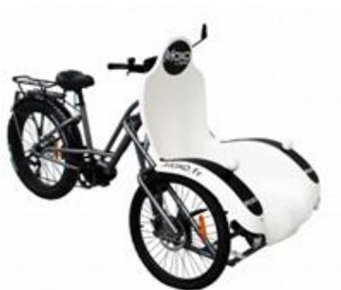
Le **Bicytoo** est un tricycle destiné au transport des personnes en situation de handicap en capacité de réaliser un transfert et aux personnes n'étant pas en capacité de pédaler.
