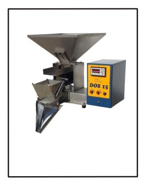
La pesatrice elettronica DOS15 è dotata di monocanale a doppia vibrazione. Nella versione standard, munita di tramoggia di carico in acciaio inox è particolarmente adatta alla pesatura di prodotti di granulometria medio/fina.
