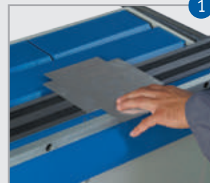
Etape 1 : Positionnez la pièce sur la table magnétique et ajustez sur le tablier inférieur
