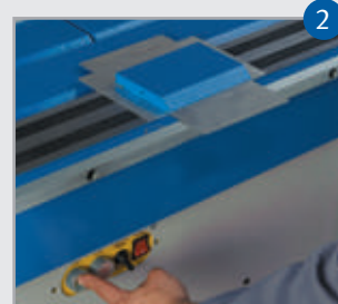
Etape 2 : Sélectionnez le segment approprié, placez-le sur la pièce à usiner et activez l'électro-aimant
