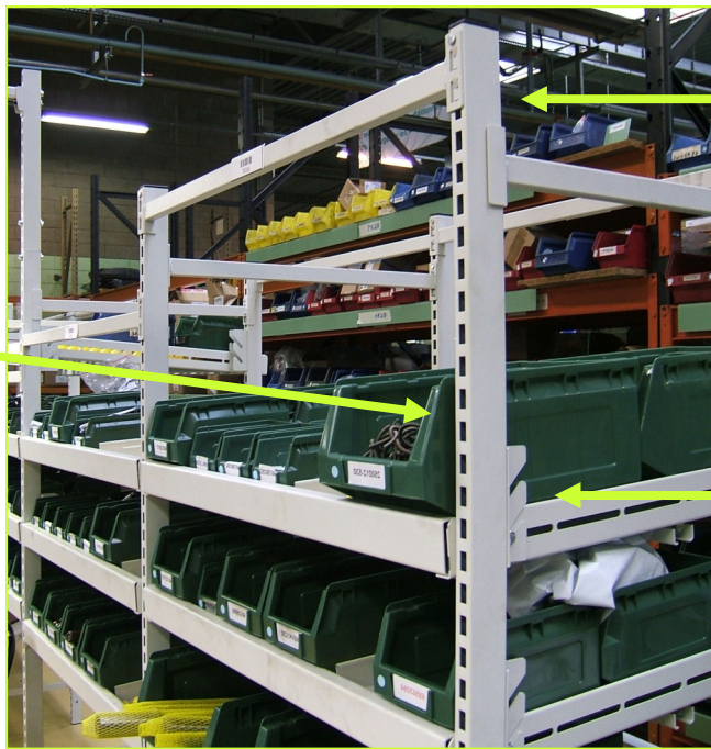
Montants perforés avec réglage des nappes tous les 33 mm
