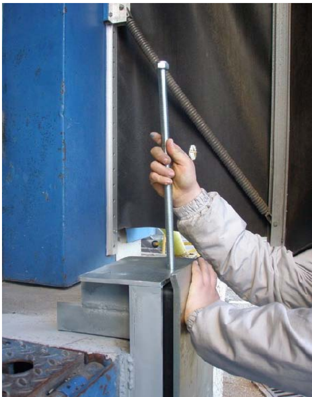
Fixation du capot mobile avant par une tige filetée verticale de fort diamètre
