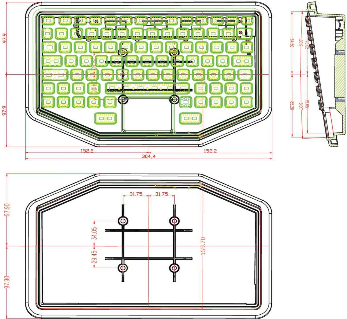
**Possibilité de fixation sur support au moyen de 4 vis sur les 4 inserts présents sur le fond du boîtier**
