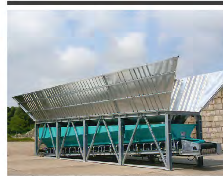
Groupe de stockage LOGIK WL 4 en cours de montage
