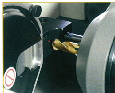
Détection et positionnement du foret avec un palpeur à fibre optique
