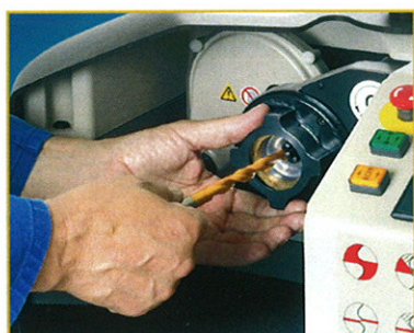
Insertion du foret dans le mandrin de précision capacité 3,0–16 mm
