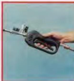
La manette permet de commander aussi bien le mouvement ascendant que le mouvement descendant. Les deux mouvements peuvent être dosés et effectués sans paliers. La facilité d'utilisation en une seule main.
