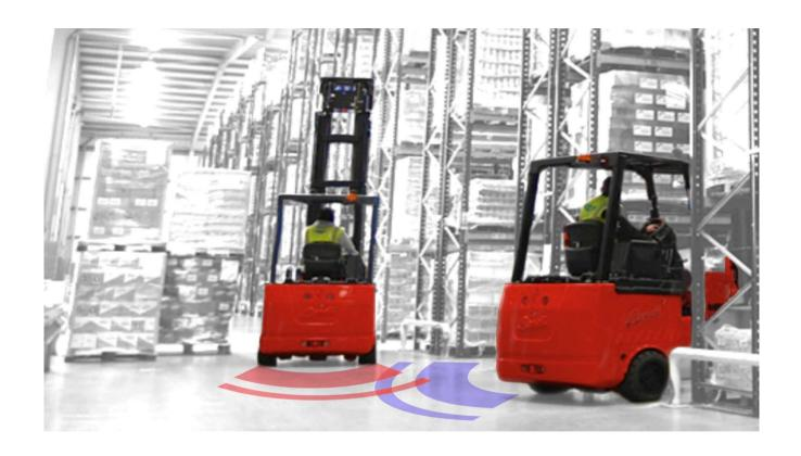
La solution SAC2 est conçue pour une détection de machine à machine à des distances qui peuvent être considérées à risque, fondamentalement dans les zones sans visibilité; il est important que les conducteurs d'un chariot élévateur, connaissent l'existence d'une autre machine dans la même zone
