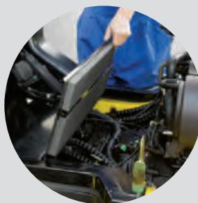
Plancher retirable d'un seul geste, sans outils
