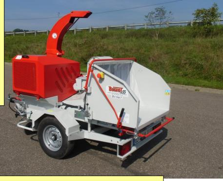
Accès très facile au rotor, au rouleau et à la contre-lame par simple basculement de l'éjection
