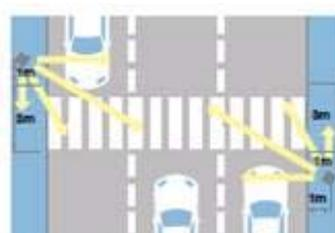
**Rue à double sens** : un minimum de deux luminaires est nécessaire pour créer un contraste positif pour le trafic dans les deux sens.
