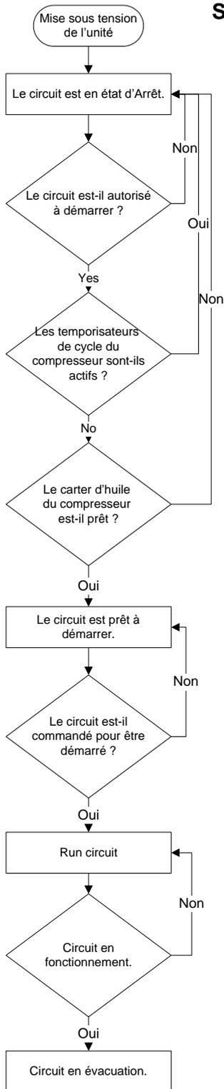
Lorsque le circuit est en état d'Arrêt, la VDE est fermée et le compresseur et tous les ventilateurs sont arrêtés.
