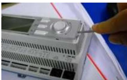
Faire attention pour éviter d'endommager le couvercle. La nouvelle batterie peut être placée dans le support de batterie prévu à cet effet, lequel est surligné dans la photo suivante, en respectant les polarités indiquées sur le support lui-même.
