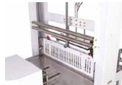
Système pneumatique pour pousser le produit vers le tunnel.
