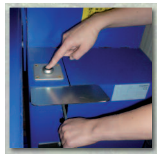
Opération à deux mains (sécurité)
