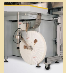
Les portes bobines sont situés sous la plate-forme de la MTX, réduisant ainsi la manutention L'enrouleur de papier gardera le poste de travail net
