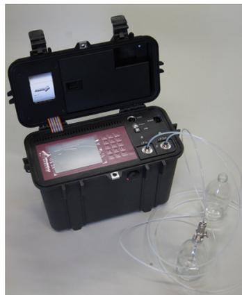
*Pour l'échantillonnage bouteille, le PAMAS S40 GO AVTUR est équipé d'une sonde de prélèvement.*
