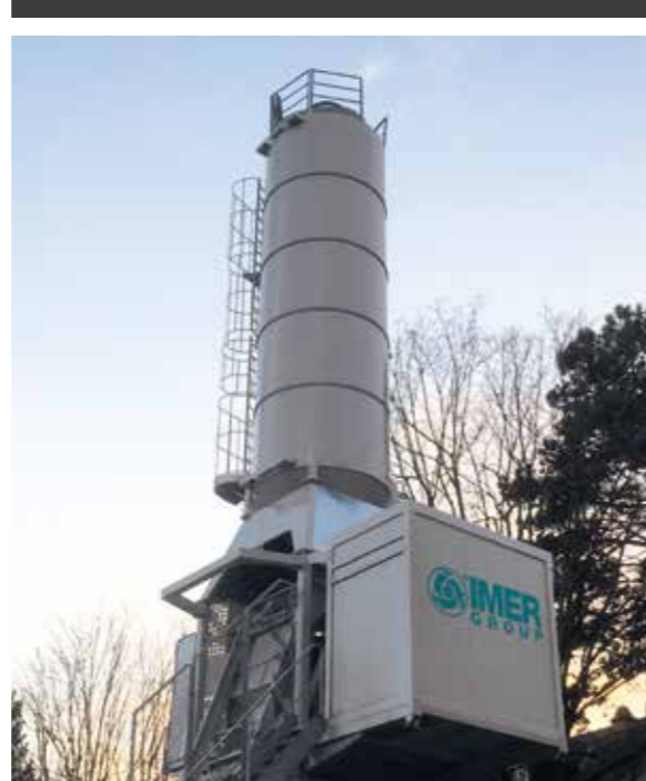
Groupe de malaxage ORUSTK 25-30-35 à chargement agrégats avec rayon raclant et skip peseur, malaxeur planétaire ORU MS et cabine intégrés même en phase de transport.
