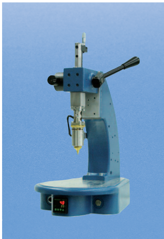
Machine de pose thermique KVT 02 à levier manuel pour l'assemblage d'inserts en faible quantité
