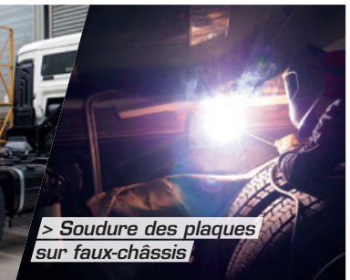
> Préparation du châssis pour fixation de la cuve
