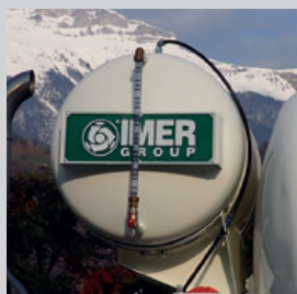
> Réservoir en acier pressurisé de 315 à 650 litres
