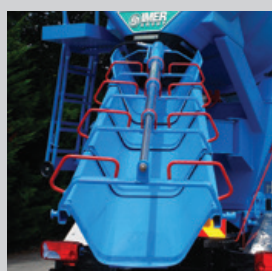
> Goulotte télescopique LT 555 déploiement à 5,5 m
