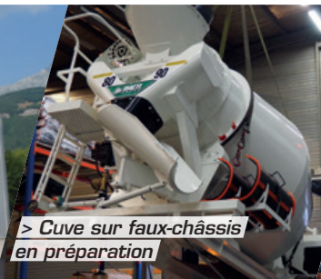
> Préparation du châssis pour fixation de la cuve
