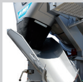
> Blindage anti-usure sur la trémie et la goulotte de vidange
