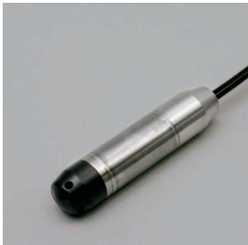
Les transmetteurs de niveau de la série 681 possèdent une cellule de mesure piézorésistive encapsulée. 13 plages de pression à partir d'une fin d'échelle de 100 mbar sont disponibles.
