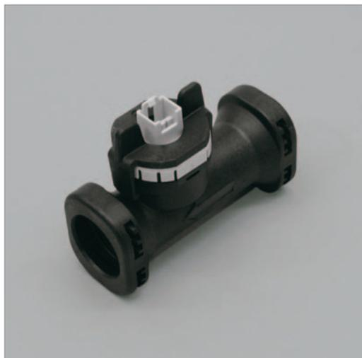
Les débitmètres de cette série reposent sur le principe des chemins de vortex de Karman. La fréquence des turbulences générées par l'obstacle situé dans le passage du débit est strictement proportionnelle à la vitesse d'écoulement.
