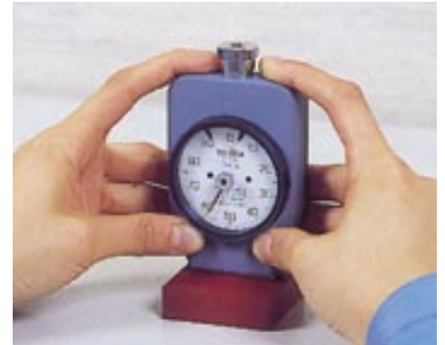
Position des mains sur le duromètre pour un bon contrôle
