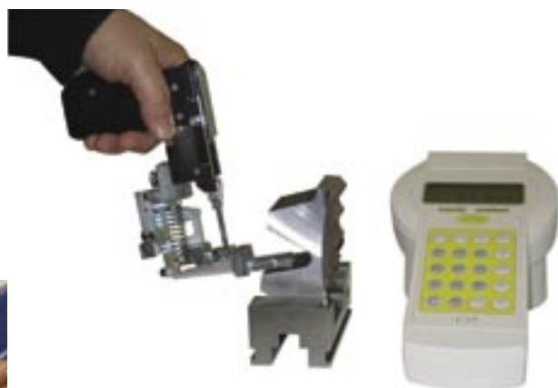
Contrôle de dureté sur une dent d'engrenage avec l'accessoire à pénétrateur déporté. Réf. 208
