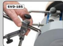
**Dispositif pour gouges**
