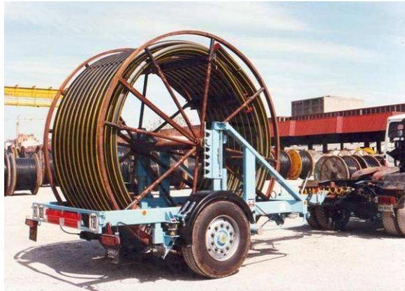
La dérouleuse S 5000 est une remorque polyvalente, capable de transporter et dérouler des tourets de tube polyéthylène de grand diamètre ainsi que des tourets de câble de masse importante. Les manutentions sont rapides et aisées grâce à deux vérins hydrauliques manoeuvrables séparément pour faciliter le chargement d'un touret en dévers.
