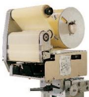
Notre technique de pose de face, bouteille à l'arrêt, assure une précision inégalée, insensible à la conicité du col de la bouteille.
