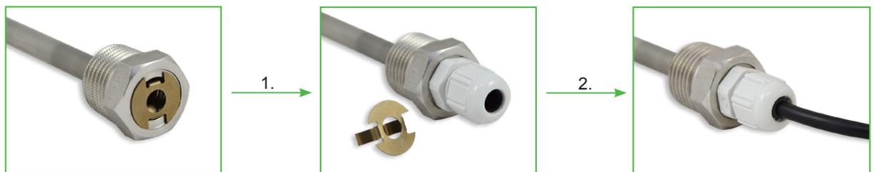
1. Le ressort à l'intérieur du doigt de gant doit être retiré et remplacé par un presse étoupe standard M12x1.5 (non inclus dans la livraison).
