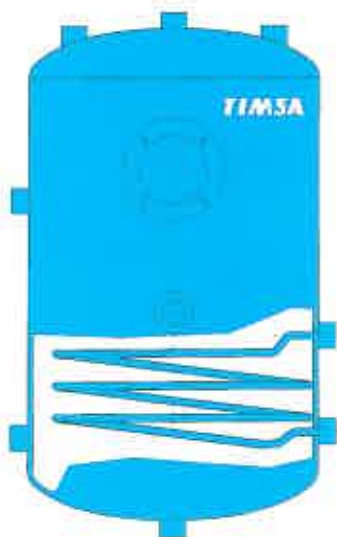
Térmosiphon avec serpentin de réfrigération, capacité 5 à 50 litres.
