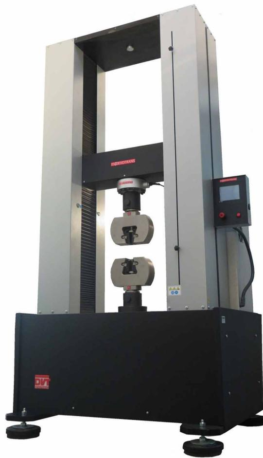
EQUIPEMENT D'ESSAI UNIVERSEL UTILISE DANS LES ESSAIS DE TRACTION ET DE COMPRESSION A HAUTE CAPACITE
