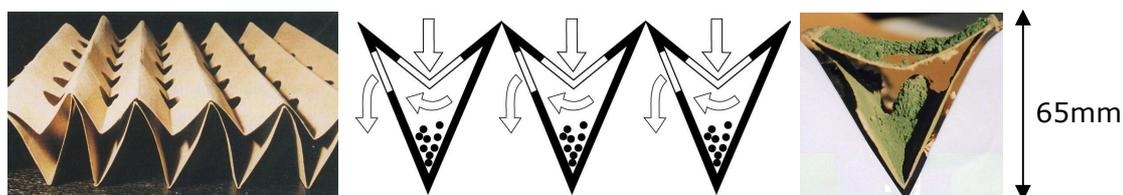
La forme du filtre permet un effet venturi (accélération de la vitesse d'air à l'intérieur du filtre) et oblige le flux d'air chargé de particules à changer de direction. Les particules de peinture, étant plus lourdes que l'air, se collent aux parois du filtre tandis que l'air propre continue à circuler au travers du filtre.
