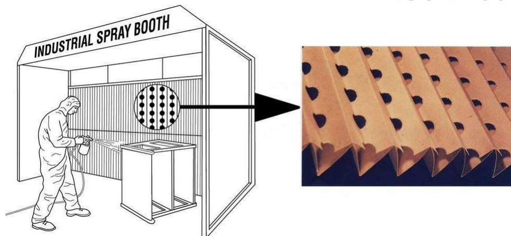
Le Filtre Carton Plissé est constitué de 2 couches de carton, perforées, plissées et assemblées avec de la colle vinylique (Carton Interkraft Recyclé 250 g/m<sup>2</sup>). La qualité du carton garantit le maintien et la rigidité du filtre.
