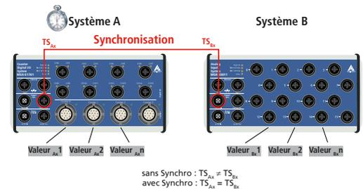
La combinaison de la synchronisation et de l'horodateur (TS) permet d'attribuer de manière univoque les signaux détectés par plusieurs systèmes.
