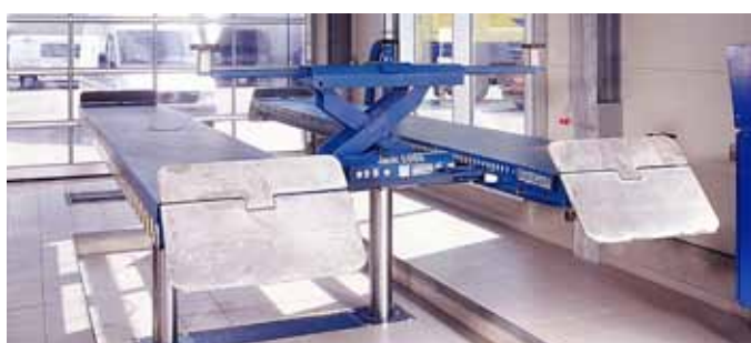
TTA rampe d'accès
