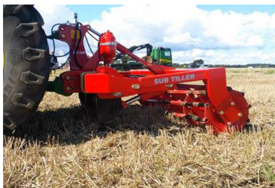
3,00 m Sub-Tiller avec sécurité hydr. automatique, 4 dents, rouleau tubes carrés et réglage hydr. de la profondeur
