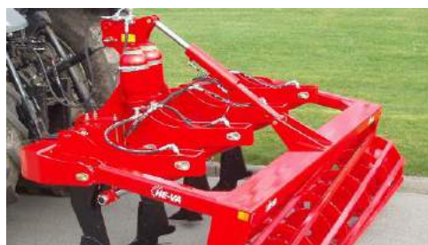
3,00 m Sub-Tiller avec sécurité hydr. automatique, 4 dents, rouleau tubes carrés et réglage hydr. de la profondeur
