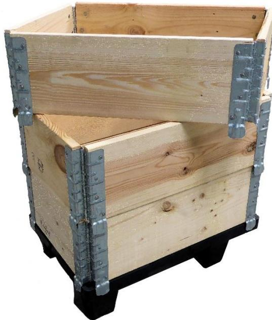
Les rehausse pliantes en bois sont fabriquées en bois résineux surfacé et chanfreiné. Les rehausse sont adaptées aux préparations de commande ainsi qu'aux transports navettes : Elles sont pliables donc économie de fret retour. Hauteur de prise : 30 mm
