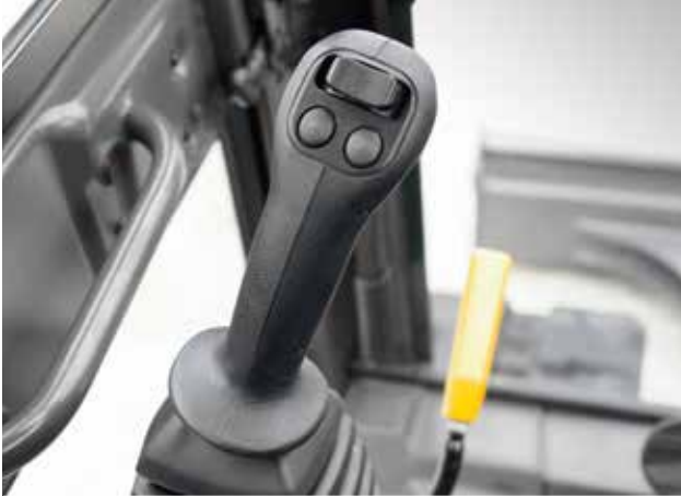
Commande de la lame de remblayage par un contacteur intégré au manipulateur gauche
