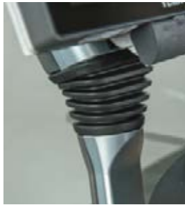
Le terminal Vario peut être réglé dans toutes les directions, grâce à un nouveau support à rotule.
