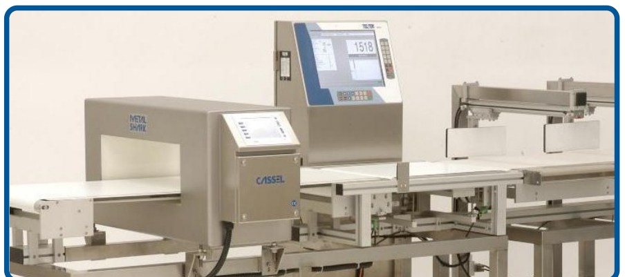
Exemple de combiné : trieuse pondérale et détecteur de métal
