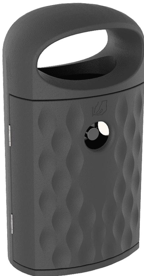
Corbeille en polyéthylène de haute densité avec épaisseur de 4mm. Finition coloris noir forge d'aspect rugueux. Résistante aux rayons UV, agents chimiques et impacts. Cendrier en acier inoxydable. Serrurerie en acier inoxydable AISI 304. Ancrage recommandé : au moyen de quatre boulons à expansion Ø10 en fonction de la surface et du projet.
