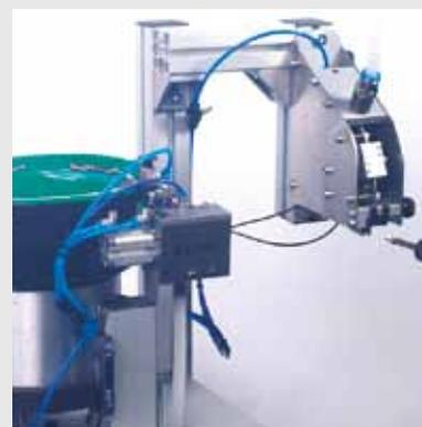
La photo montre une prise semi-automatique de vis avec un outil pneumatique Fiam
