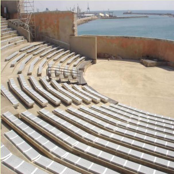
Siège fabriqué en polypropylène copolymère injecté teinté dans la masse. Fixation par point d'ancrage latéral 2 points et nervures de renfort anti-vandalisme. Etanchéité siège/gradin réduisant l'entretien et les risques d'arrachement. Orifice de drainage. Aspect de surface lisse et semi-brillant. Entraxe 450, 475 ou 500 suivant utilisation du simple ou double pont. Ponts pouvant être d'une couleur différente de l'assise.
