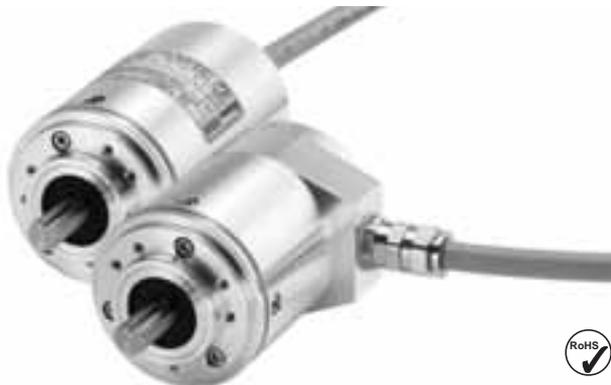
Le codeur absolu multitours Sendix 7068 avec interface CANopen et capteurs optiques offre la protection Ex dans un boîtier compact et robuste de 70 millimètres en aluminium résistant à l'eau de mer.
