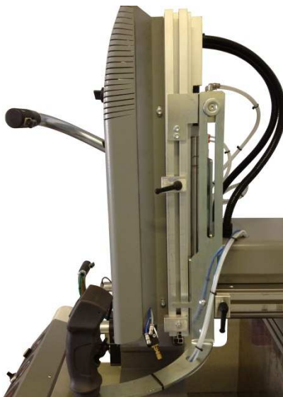
Blocage pneumatique de l'axe Z.
