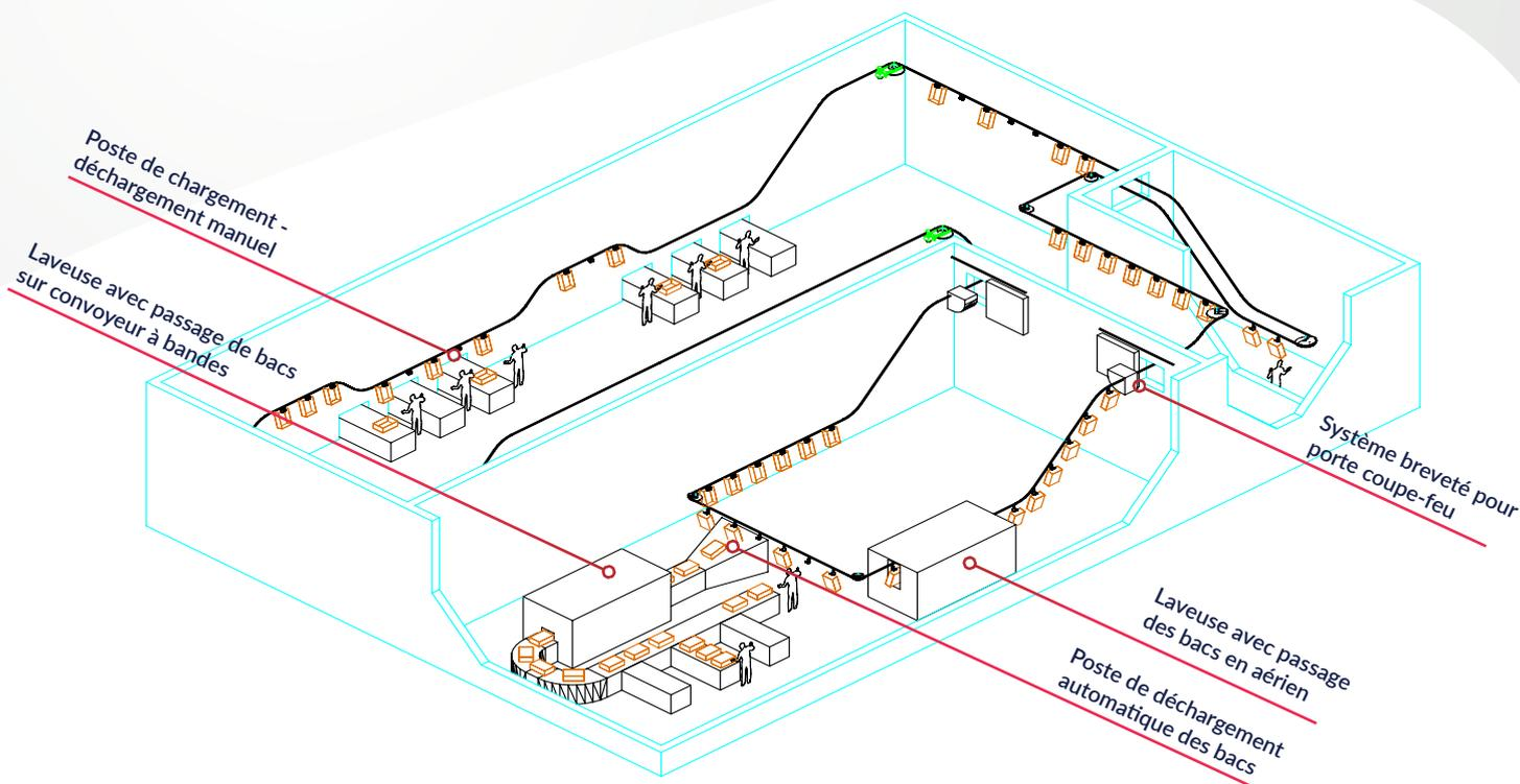
Calypso est un convoyeur à câble monorail en circuit fermé. Il s'agit d'un système de manutention aérienne simple, propre (conçu pour être nettoyé facilement) et silencieux, qui demande peu d'entretien.
