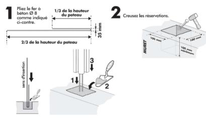
Insérez les fers à béton, scellez, puis insérez les poteaux aluminium en les enfonçant de quelques millimètres dans le scellement.
