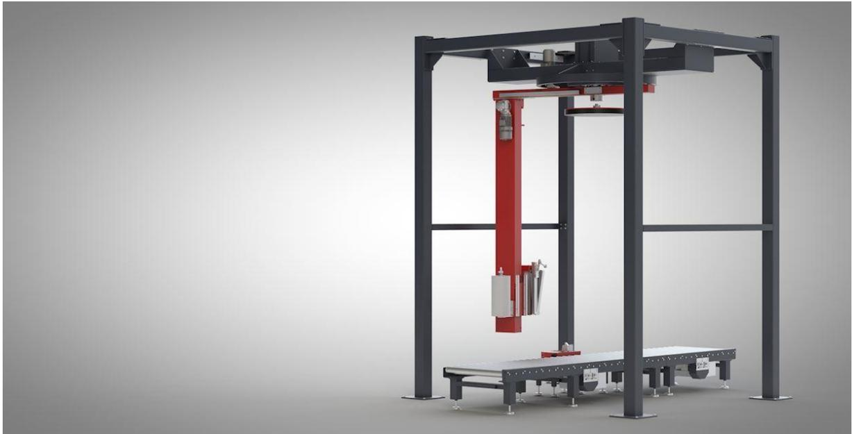
Enrouleuses automatiques pour emballer des charges instables, l'emballage se fait en tournant les colonnes alors que la charge reste immobile. Conçu pour être intégré en ligne, sans aucune intervention de l'opérateur. Entièrement personnalisable avec une large gamme d'options et d'éléments accessoires qui permettent d'avoir la solution parfaite pour chaque exigence de production et chaque environnement de travail.
